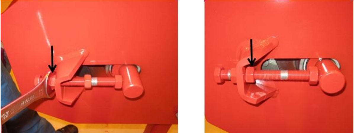
Kuva 4 (Ketjukuljettimen ketjujen kireyden säätö)
