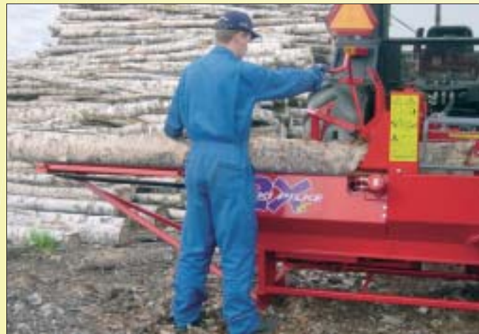
Avance du bois par courroie, tronçonnage par la scie à chaîne. Modèle "EASY"
