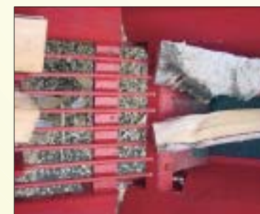
Après avoir été fendus, less morceaux de bois passent au-dessus d'une grille qui laisse passer les sciures et les éclats de bois.
