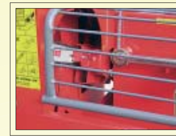
En relevant la grille de protection de la fendeuse, la scie est automatiquement bloquée dans sa position relevée.
