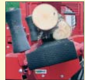
Le convoyeur est légèrement incliné pour garder le bois sur la table.
