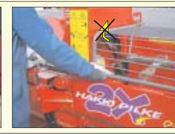
Arrêt d'urgence de la fendeuse et recul.
