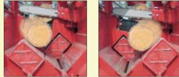
Guidage automatique de la bûche vers le canal de fendage libre.
