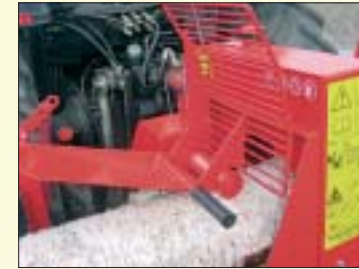
La grille d'entrée s'ouvre par l'action du rouleau d'appui monté sur ressort.
