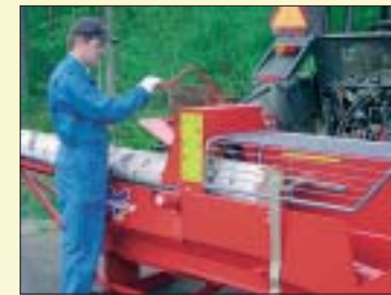
Position de travail ergonomique. Tronçonnage et fendage ont lieu derrière des grilles de protection.
