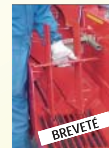
L'attache rapide facilite le remplacement et l'entretien des lames.
