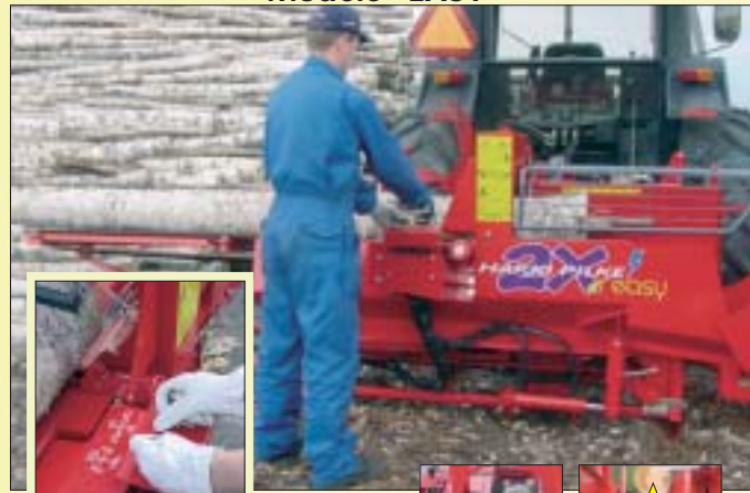
Avance du bois par courroie, tronçonnage par la scie à chaîne. Modèle "EASY"
