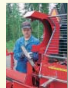
Le boîtier de la scie peut s'ouvrir pour accéder facilement à la scie à chaîne.
